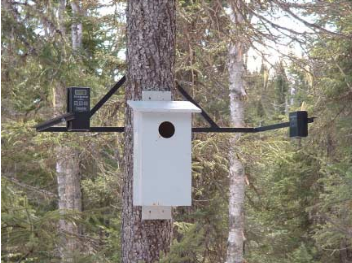
Figure 4. Installation d'un détecteur de mouvement Trailmaster TM1550 permettant l'enregistrement des entrées et sorties d'un nichoir par les nyctales
