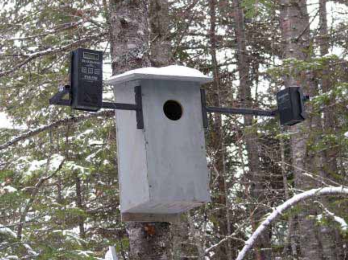
Figure 3. Installation d'un détecteur de mouvement Trailmaster TM1550 permettant l'enregistrement des entrées et sorties d'un nichoir par les nyctales
